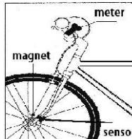
Po vložení baterie do komputera se na obrazovce zobrazí hodnota 2060, s blikajícím prvním číslem – komputer je připravený k nastavení obvodu pláště, dle následující tabulky. Pravým tlačítkem měňte hodnotu právě blikajícího čísla, levým tlačítkem pak tuč hodnotu potvrďte a postoupíte na číslo další. Následným opětovným stlačením levého tlačítka přejdete k nastavení režimu Km/h, Mile/h
